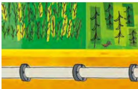
*Profondeur minimale d'enfouissement de la conduite : 1,6 mètre en milieu agricole et 1,2 mètre en milieu boisé, dépassant ainsi les normes de l'industrie.*
