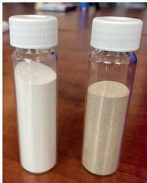
Les composés organiques volatils (COV) sont traités dans un système de catalyseur en circuit fermé, où ils sont brûlés pour éliminer ceux formés lors des réactions chimiques. Le catalyseur, qui est initialement beige en raison du carbone fixé aux particules, redevient blanc lorsqu'il est brûlé.
