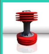
*Sonde intelligente : équipement en forme de « torpille » qu'on fait voyager à l'intérieur d'une conduite hors-service et vide. Elle passe à l'intérieur de la conduite en faisant des rotations sur elle-même tout au long du tracé. Les senseurs de la torpille permettent de mesurer l'épaisseur de la paroi et accumulent des données sur l'intégrité des matériaux de la conduite.*
