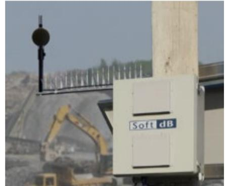
Sonomètre utilisé pour le suivi du bruit
