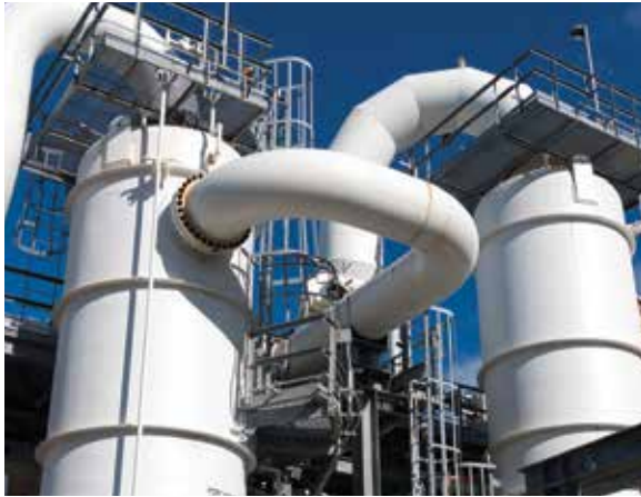
▲ Des systèmes de récupération des gaz de torchère, comme celui-ci à la raffinerie Bill Greehey, captent et recyclent les gaz.
